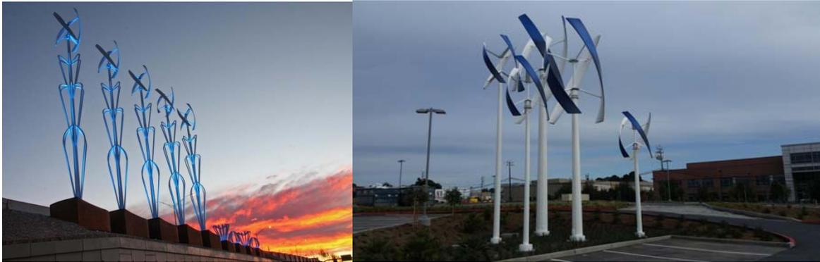
Ilustración 26: Aerogeneradores verticales con diseños integrables en el mobiliario urbano
