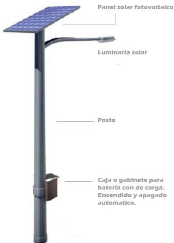
Ilustración 22: Componentes de una farola solar
